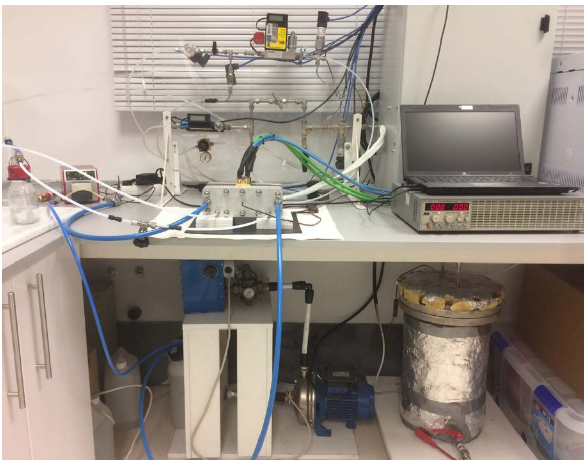
Figura 9. Banco de pruebas de AIJU para la caracterización de pilas de combustible tipo PEM.
